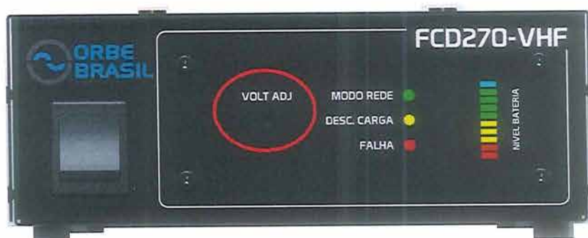
Figura 6 – Trimpot VOLT ADJ (Ajuste de Tensão de Saída)
